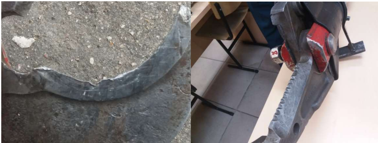
Рис. 1. Износ рабочих элементов гидравлического инструмента
