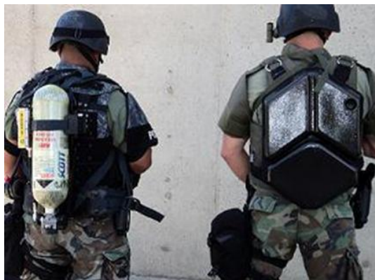
Рис. 2. Сравнение стандартного баллона ИДА и воздушных пакетов Slim-systems (вид сзади)
