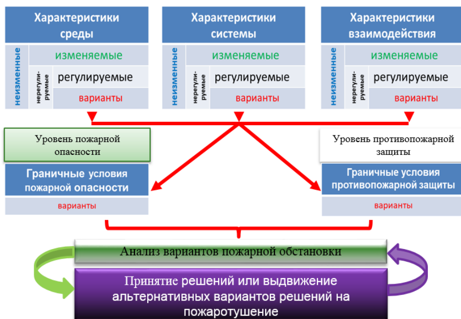
Рис. 2. Структурная схема процесса анализа пожарной обстановки
