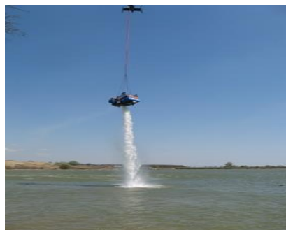
Рис. 1. Вертолетное водопеносливное устройство ВВСУ с УКТП «Пурга»
